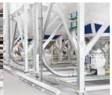
Sistema di pesatura silo
