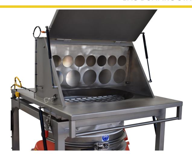
SVUOTAMENTO MANUALE DI SACCHI DI MATERIALE IN POLVERE O GRANULARE
