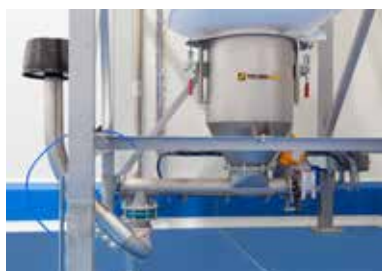
Sistema di aggancio e slacciamento a tenuta polvere Dust tight docking system
